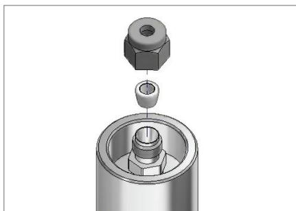
4. Вставьте уплотнительный наконечник в корпус фитинга и зафиксируйте его с помощью гайки.
