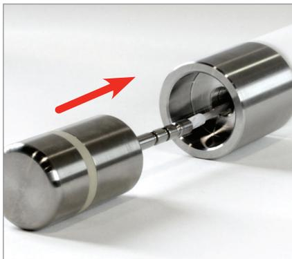
2. Протяните измерительный зонд через отверстие в нижней части термочехла.
