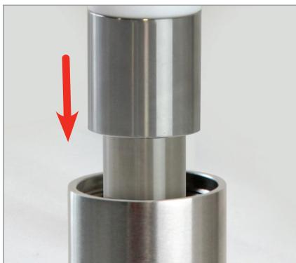
4. Вставьте даталоггер вместе с нижней частью термочехла в корпус и плотно закрутите крышку.
